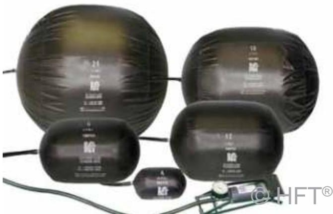
Bolsas hinchables disponibles en forma cilíndrica o esférica. Su uso más común es el taponar las líneas ya existentes para reparaciones, mantenimiento y añadir nuevas secciones.
